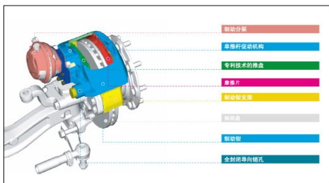
在过去，由于卡车的摩擦片比较大，为了避免楔形磨损，必须使用两个推杆。调整间隙时，需要使用十分复杂的调整机构对两个推杆进行同步调整，增加了系统的质量而且由于零件数量多也增加了损坏的概率。WABCO对此进行了改进，推出了PAN系列单推杆促动调整机构。
