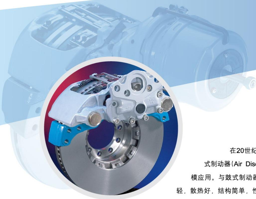
在20世纪90年代中期的欧洲，气压盘式制动器(Air Disc Brake)在商用车领域被大规模应用。与鼓式制动器相比，盘式制动器具有质量轻，散热好，结构简单，性能稳定，易于调整间隙等优点。目前盘式制动器在欧洲商用车已普遍应用。
